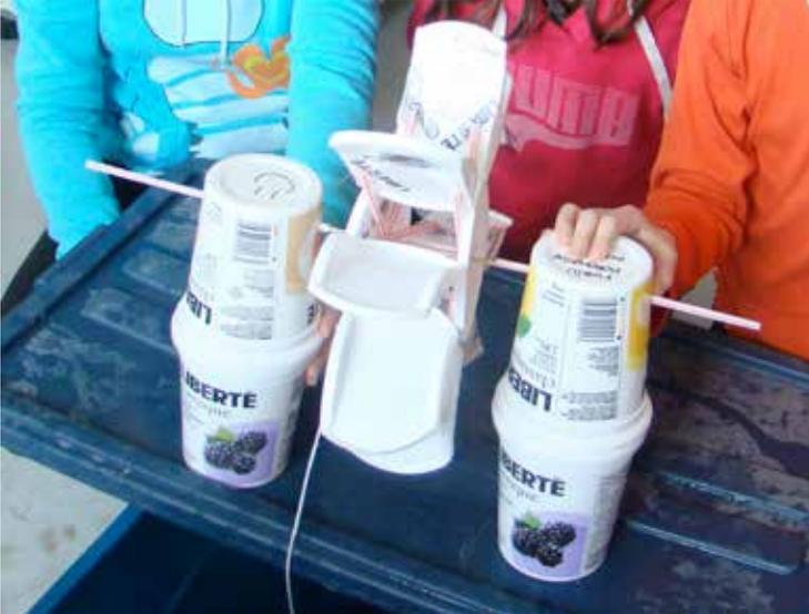
Exemple de prototype réalisé avec des pots de yogourt vides et des pailles. Le crayon est attaché au bout de la ficelle. Lorsque la roue tourne sous l'effet de la chute d'eau, la ficelle s'enroule et le crayon remonte.
